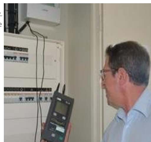
LES ENREGISTREURS DE TENSION MESURENT LA QUALITE DE FOURNITURE DES USAGERS.
